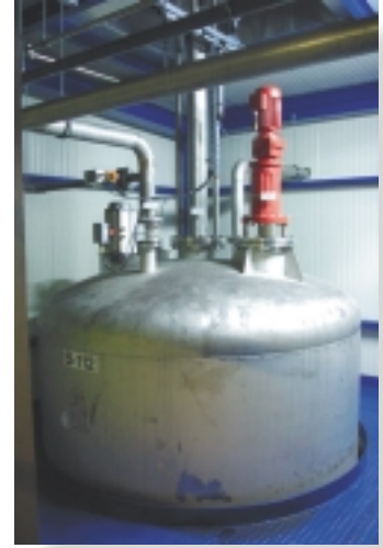
2: Die Dispergieranlage gewährleistet ein optimales Suspendieren und Homogenisieren des Farbansatzes
